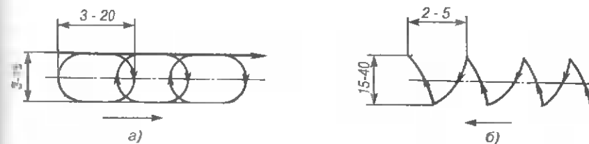
Рис. 16.4. Колебательные движения электрода при сварке порошковой проволокой: а — по спирали, б — змейкой
