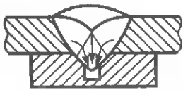
Рис. 20.1. Подкладка для сварки алюминиевых сплавов
